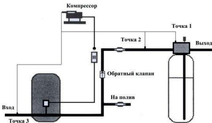
Рис.1 Варианты подачи воздуха в водопровод.
